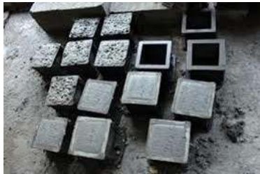
FIG NO: 4: CONCRETE CUBES
