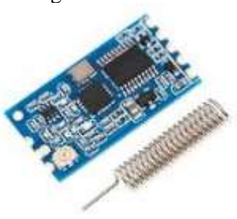
Fig:hc-12 ZigBee module
